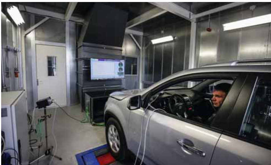
Het Walhalla, een 4WD-vermogenstestbank in een eersteklas cabine. Overbodige luxe? Niet als je inzet op diagnose en samenwerking met het bedrijfsleven.
