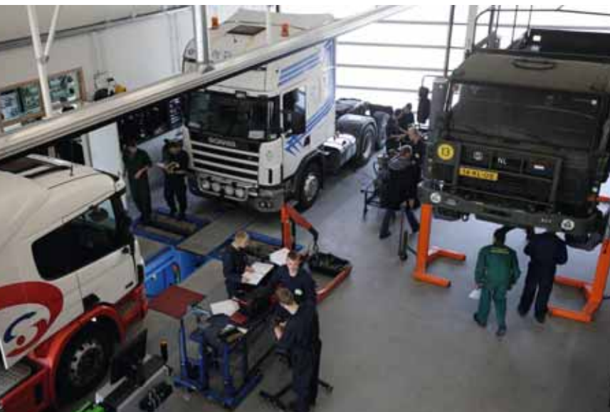
Zicht op de truckwerkplaats. De legertruck staat op hefkolommen, die radiografisch met elkaar communiceren. Links de dubbelwandige prefab put met 15-tons afdekking. Door het raam kijk je het praktijklokaal met trainingsborden binnen.
