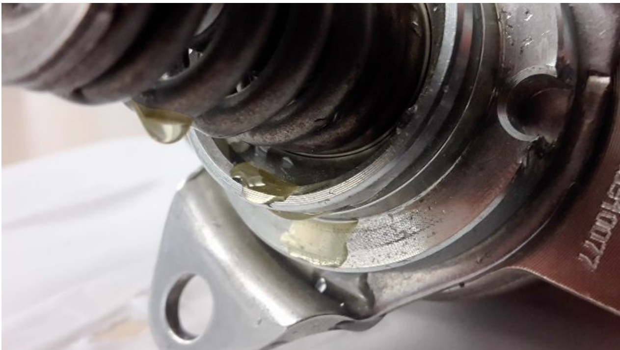
Bild 1 = Undichtigkeit der Kraftstoff-Hochdruckpumpe
